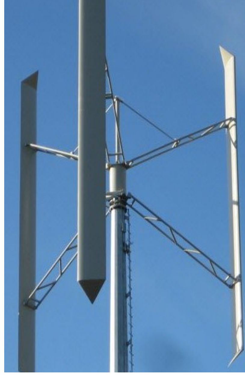
Abb. 1: H-Rotor einer VAWT
