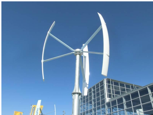
Abbildung 1: Windkraftanlage mit (klassischem) Vertikalrotor (links), veränderliche Anströmung der Tragflügel bei der Drehung des Rotors (rechts) mit der Umfangs- u , Wind- v , und der Relativgeschwindigkeit w .
