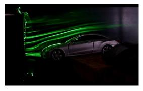
Stürmisch ging es hingegen im Labor Strömungstechnik/-maschinen zu, da hier die drei Schüler einen Windkanal mit einfachen Mitteln selber bauen sollten. Anhand diesem konnten mithilfe von Nebelfäden umströmte Modellautos unter Laserlicht hinsichtlich ihres Strömungswiderstandes charakterisiert werden (siehe Bild links). Die Betreuung im Labor erfolgte durch Herrn Dipl.-Ing. (FH) Felix Rothe.
