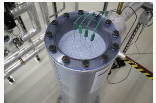
Latentwärmespeicher-Demonstrator mit transparentem Abdeckflansch und vier Kerntemperatur-Sensoren
