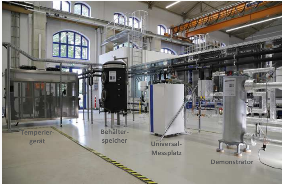
Versuchsstand „Wärme- und Kältespeichertestanlage“
