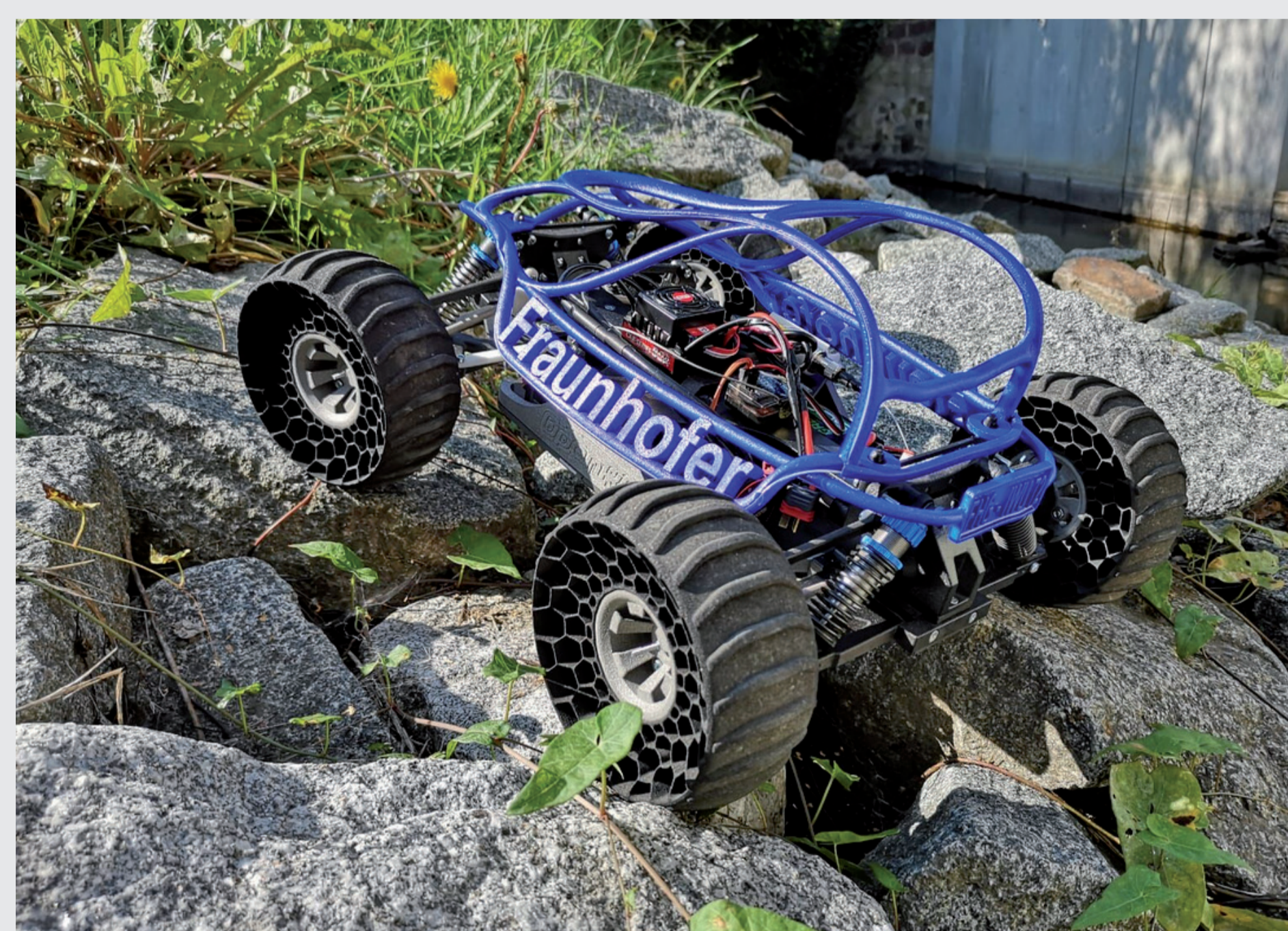
RC Buggy Karosse aus der SLS-Anlage
