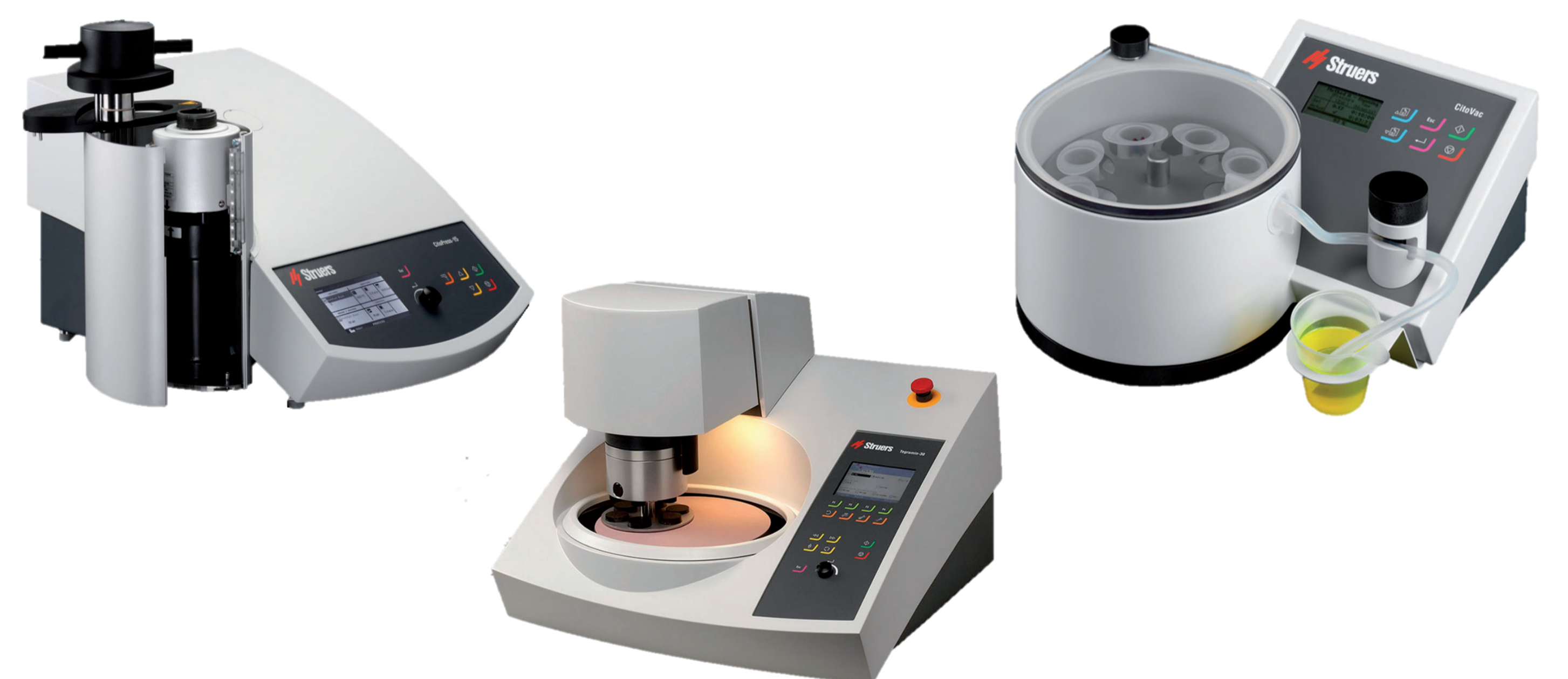
Präparationsgeräte: CitoVac, Tegramin-30, CitoPress-5 (Quelle: Struers)
