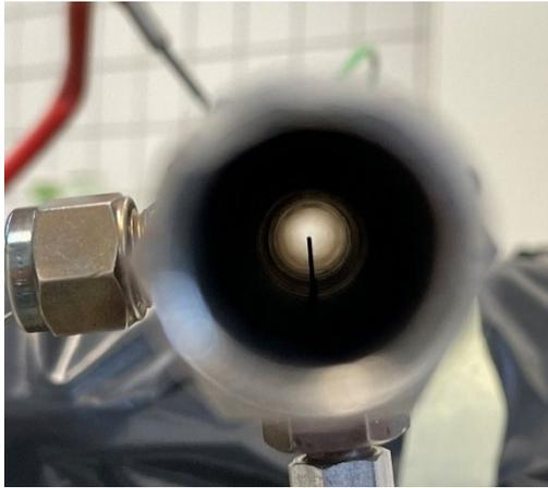
Abbildung 37: Thermoelement zur Messung der Fluidtemperatur in der Rohrmitte
