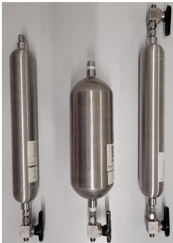
Abbildung 7 Probenahmeflaschen: 500 ml (links), 1000 ml (Mitte), 500 ml mit beidseitigem Kugelhahn (rechts)
