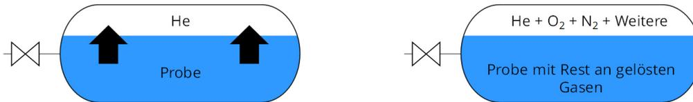
Desorption der gelösten Gase in die Gasphase
