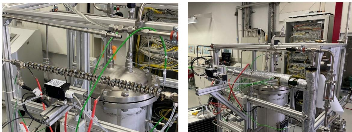
Abbildung 43: Messstrecke (ohne und mit Dämmung) integriert in Begasungsanlage an der HSZG
