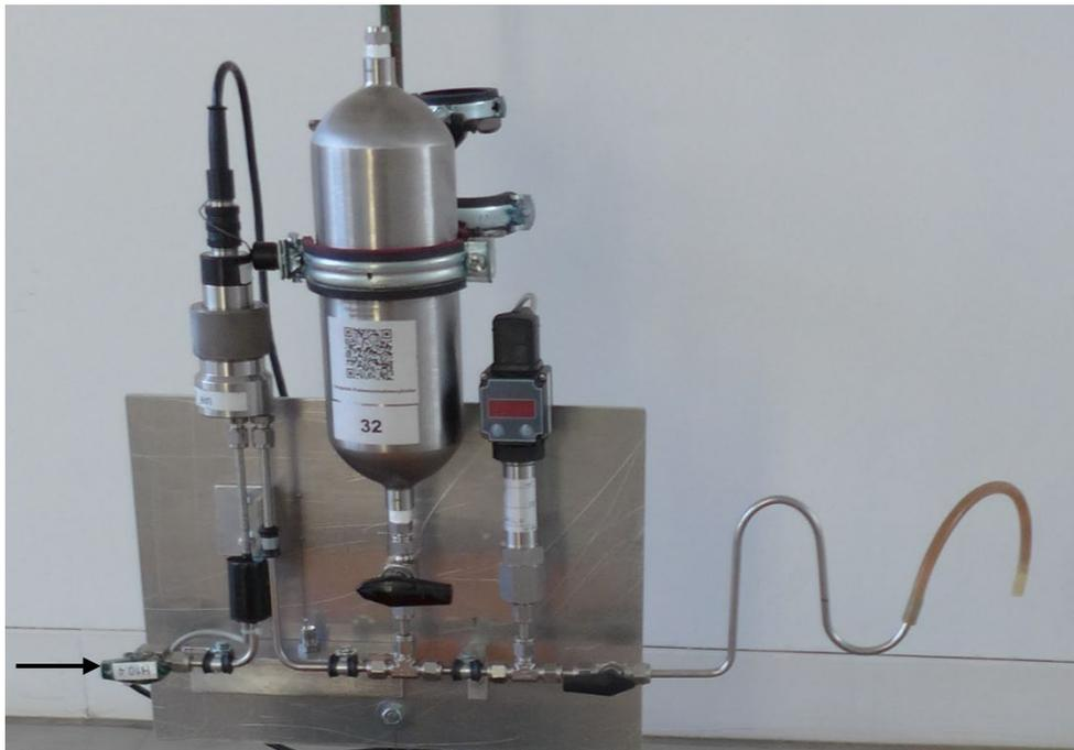
Abbildung 6 Foto der mobilen Probenahmetafel: links Anschluss ans System mit einer 1000 ml Probenahmeflasche
