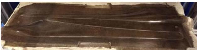
Rotorblatt einer KWEA mit einer Länge von ca. 1000mm aus NFK
