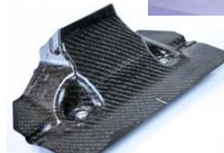
Hybrider Automobil-Batterieträger in FKV-Metall-Leichtbauweise
