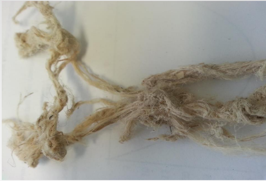
Stoffaufschluss in „fest“ und „flüssig“ Hier der Faseranteil nach einer Zwischenstufe.
