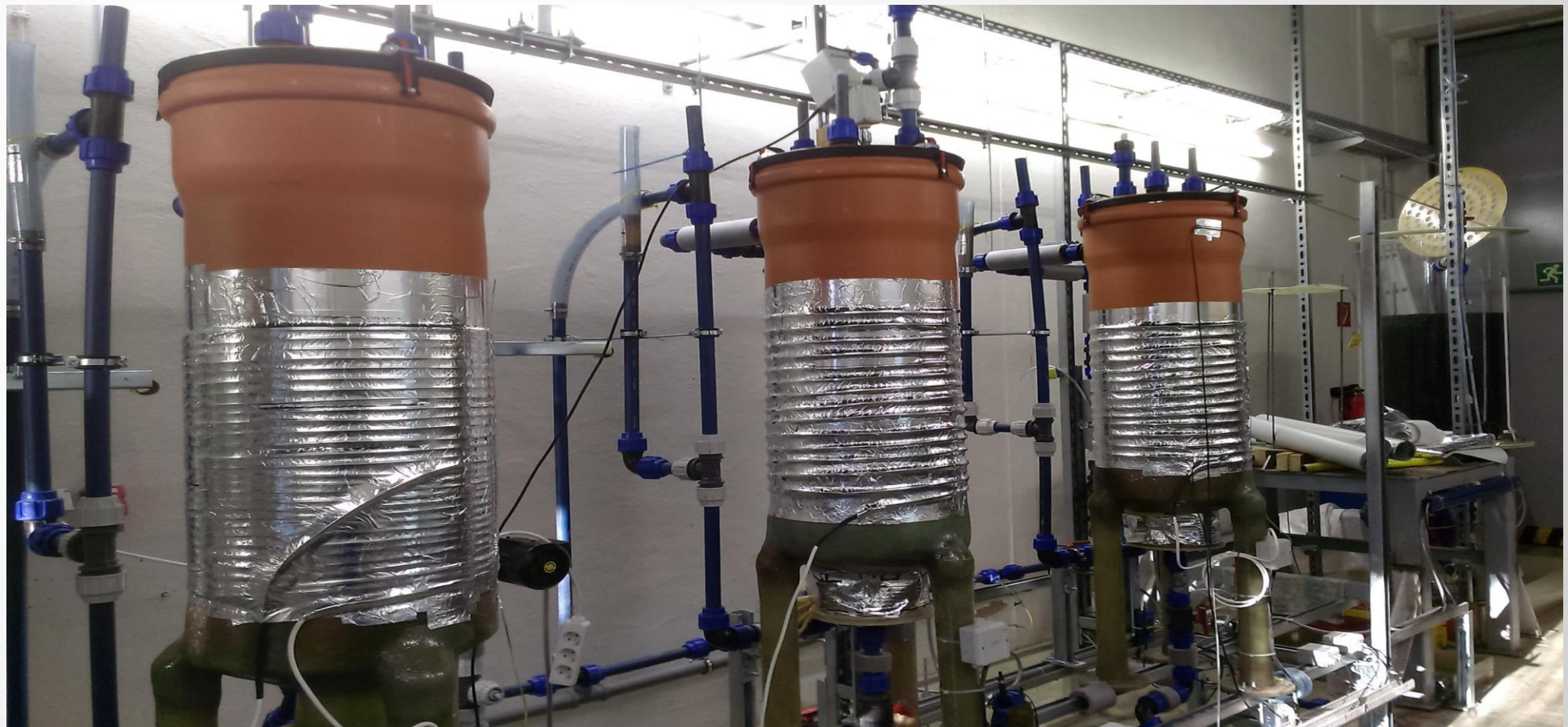
Versuchsaufbau: 3 Fermenter gleicher Bauart mit unterschiedlichem Festbett und Durchmischung Fermenter 1 - Festbett mit verformter Folie (Kühlturmeinbau) und Zirkulation über externen hydraulischen Kreis Fermenter 2 - ohne Festbett, mit Rührwerk im Behälter Fermenter 3 - Festbett aus GFK Scheiben mit Anstellwinkel und Zirkulation über externen hydraulischen Kreis
