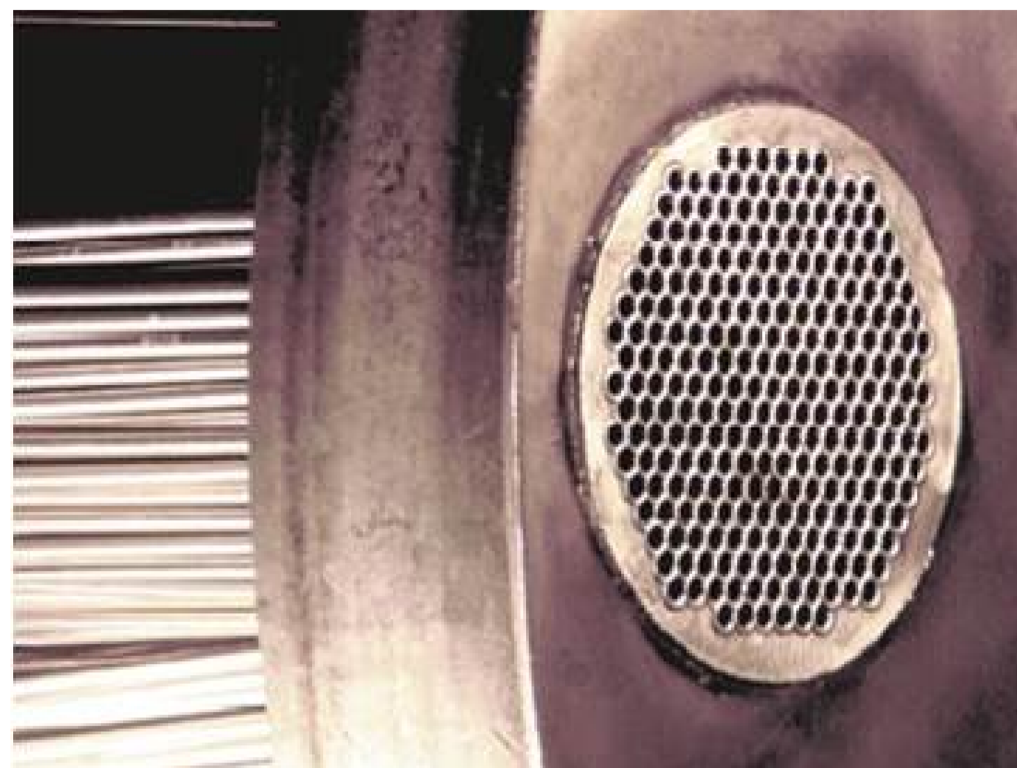
Rohr/Rohrbodenverbindung eines Wärmetauschers
